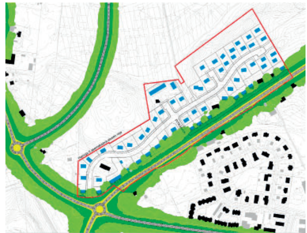
Ennustetilanne 2050 kaavaluonnoksen mahdollistamalla rakennuskannalla, yöajan keskiäänitaso LAeq (7–22)
