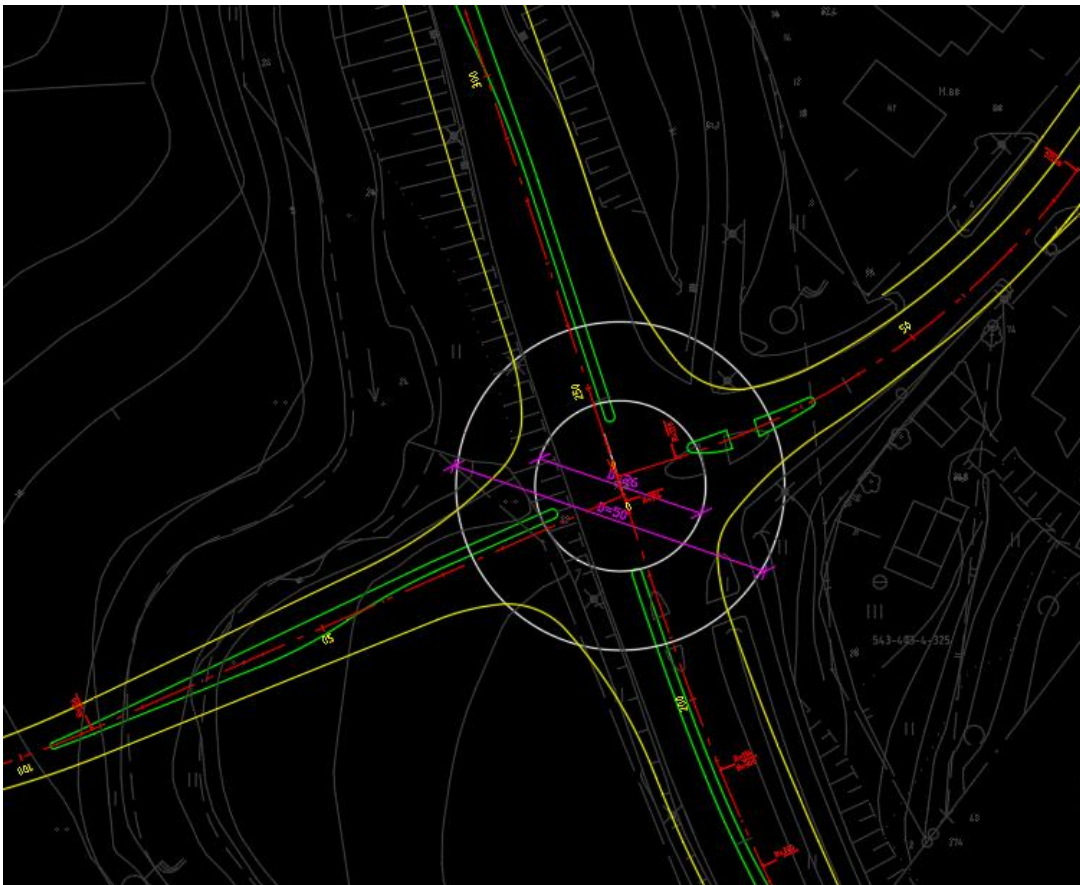
Kuva 6. Kanavoidun liittymän alustavat kaistajärjestelyt, sekä kiertoliittymän suuntaa antava sijainti ja koko (Ramboll 2021).
