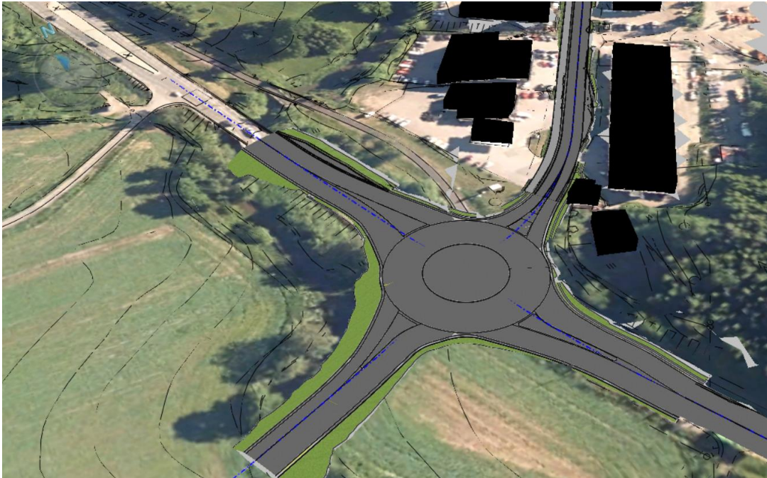
Kuva 5. Suuntaa antava mallinnus kiertoliittymän sijoittelusta. Mallissa ei ole huomioitu kevyen liikenteen, tai joukkoliikenteen järjestelyitä (Ramboll 2021).
