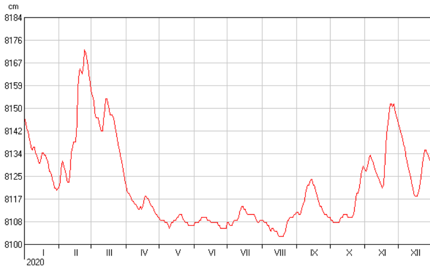
Kuva 3.36. Veden korkeus (N60) Ridasjärven pohjapadolla vuonna 2020. Kuva on Syke/Avointietorekisteristä tulostettu 20.4.2021. Rekisterissä olevat vedenkorkeustiedot ovat tarkistamattomia.
