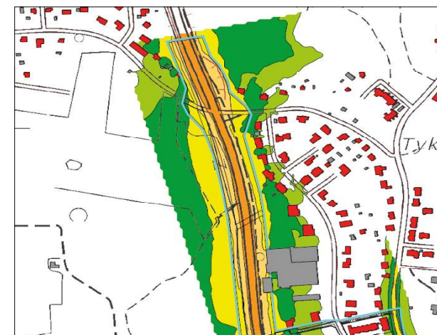
Kuva ote meluselvitys Hellaspolun asemakaava, Ramboll 2020. Rajamäentien melualue. Suunnittelualueelle ei kohdistu merkittäviä melun äänitasoja.
