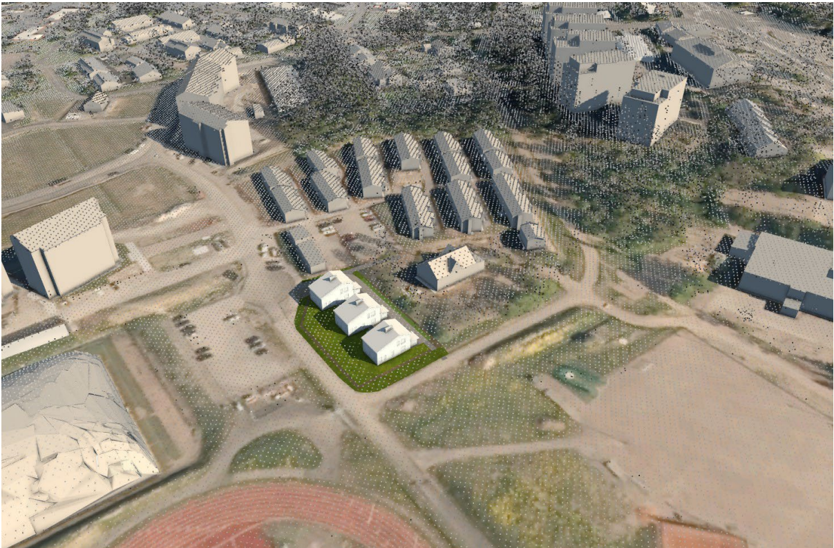
Kuva 1 mallinnus. Kuvassa näkyy MML:n maastomalli, pistepilvi ja nykyiset rakennukset (Ali-Tilkan automaattisesti tuotettu kattomuoto on virheellinen, mutta katon harjakorko kohtuullisen tarkka)
